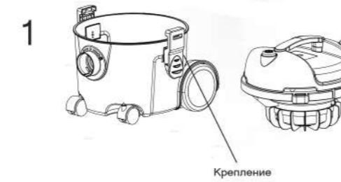
Поднимите крепления, чтобы снять верхнюю часть корпуса
