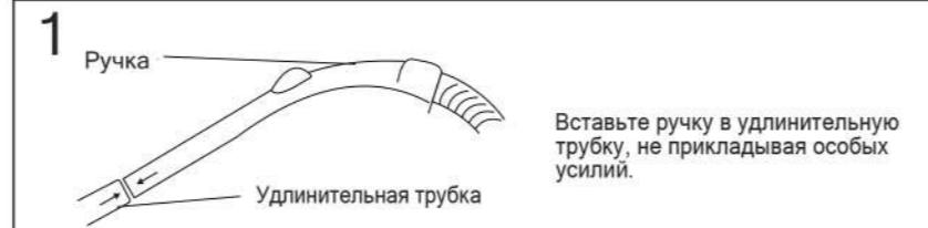
Вставьте ручку в удлинительную трубку, не прикладывая особых усилий.
