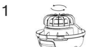
Поверните фиксирующую ручку против часовой стрелки и снимите фильтр
