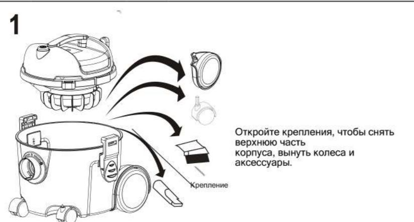
Откройте крепления, чтобы снять верхнюю часть корпуса, выньте колеса и аксессуары.
